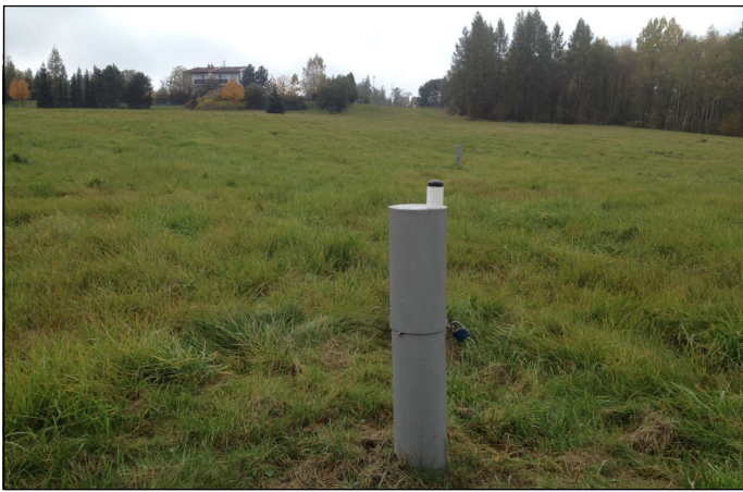
Obr.6 - GeoNet anténa (PUK) se 7cm nástavcem na zhlaví vrtu
