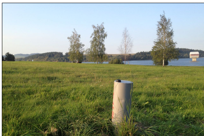
Obr.5 - GeoNet anténa (PUK) na zhlaví ochranné pažnice vrtu
