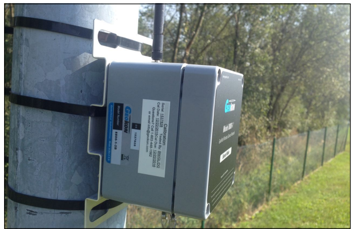
Obr.7 - GeoNet node použitý jako repeater
