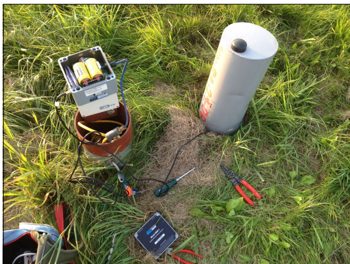
Obr.2 - Výměna dataloggeru Geokon LC-1 za GeoNet
