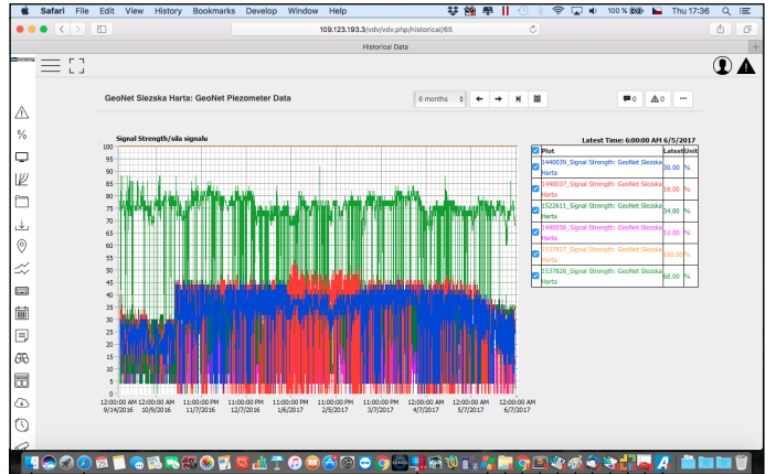
Obr.9 - Změna síly signálu po instalaci 7cm vysokého nástavce antény
